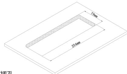
入墙安装方式开孔尺寸图
