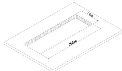
桌面安装方式开孔尺寸图
