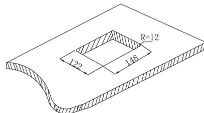
开孔尺寸图 (单位: mm)
